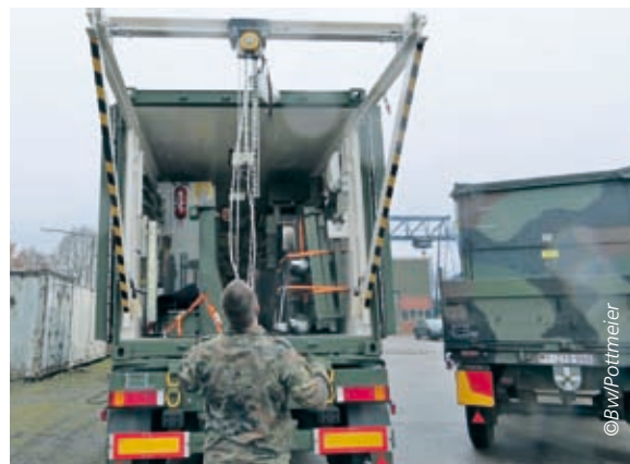
Der Türportalkran für Lasten bis zu 1.000 kg lässt sich komplett verstauen.
