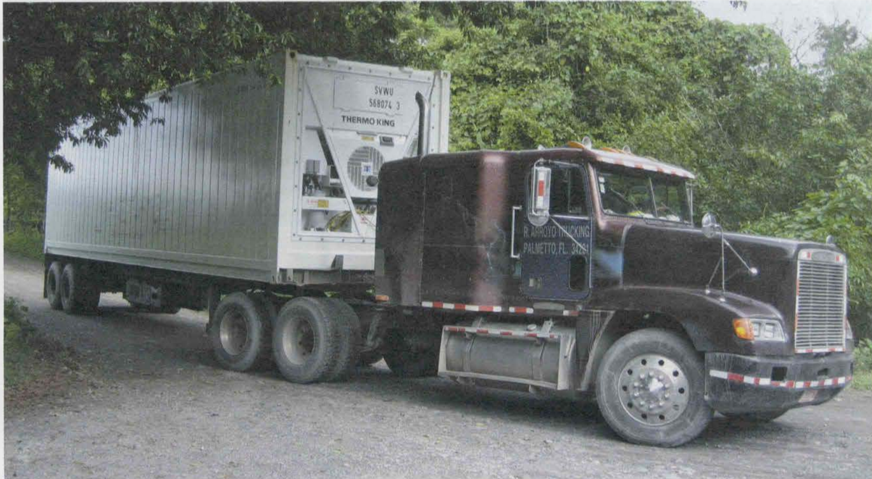
Feldtest in Costa Rica: Die Bananen im Container wurden mit Funksensoren ausgestattet. Das ermöglicht eine Online-Überwachung während des Transports. FOTOS: UNIVERSITÄT BREMEN
