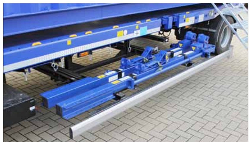
Beidseitig zwischen den Achsen des Multifunktionsanhängers werden die Segmente der Hubanlage mitgeführt.
