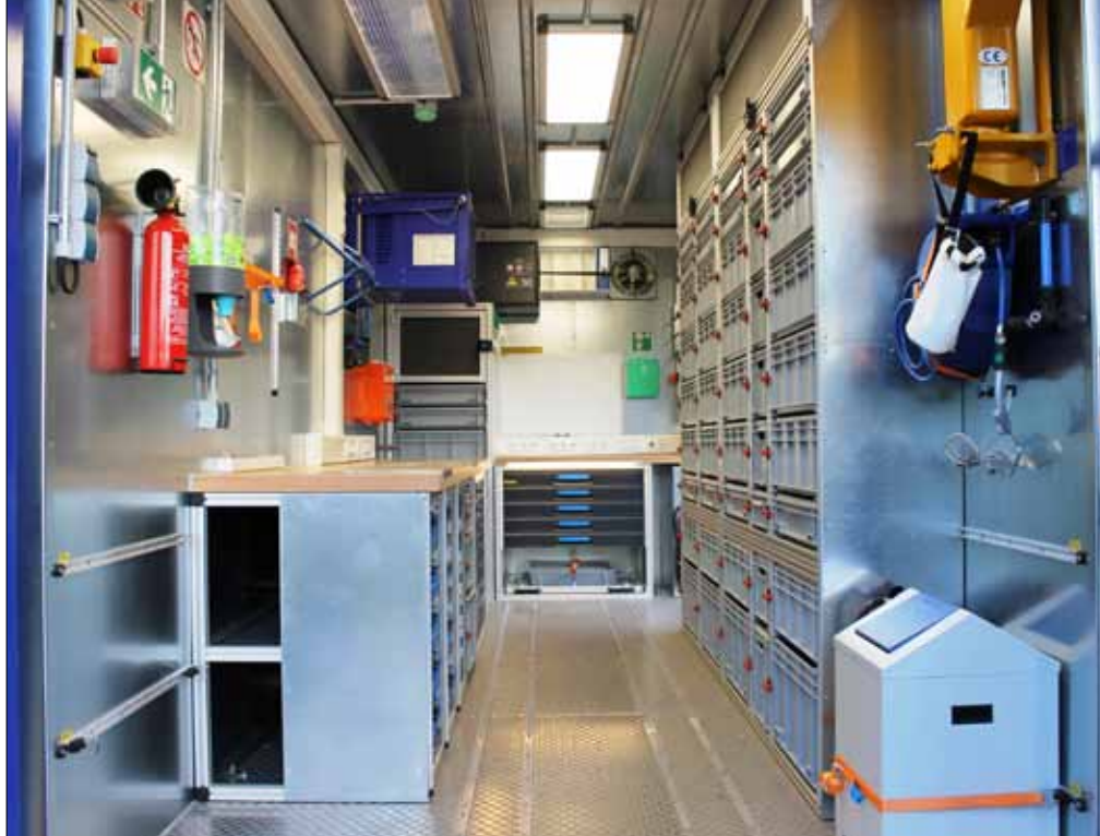
Gesamtansicht des neuen Werkstattcontainers mit Regal für Staubboxen (rechts), Werkbank (links) und Schreibarbeitsplatz (hinten).
