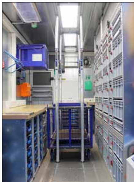
Drei dieser Rollwagen werden mitgeliefert. Mit dem Kran können sie in den Container geladen und im Mittelgang durch Sperrstangen gesichert werden.
