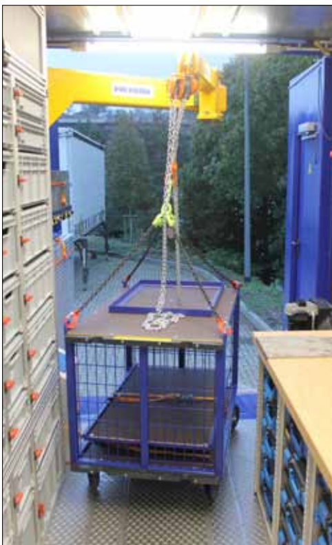
Drei dieser Rollwagen werden mitgeliefert. Mit dem Kran können sie in den Container geladen und im Mittelgang durch Sperrstangen gesichert werden.
