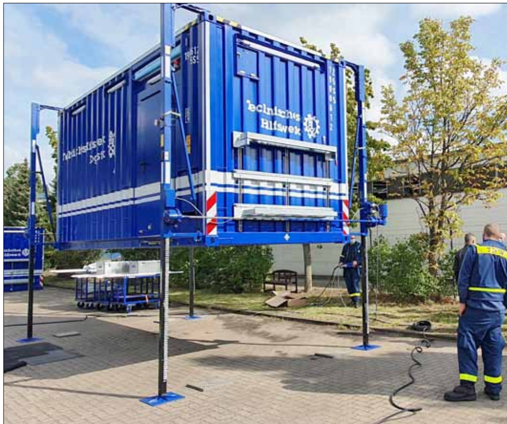
Das Stützensystem kann den Container bis zu 1,75 Meter hoch anheben. Für den Betrieb sind mindestens drei Helfer und 30 Minuten Aufbauzeit erforderlich.
